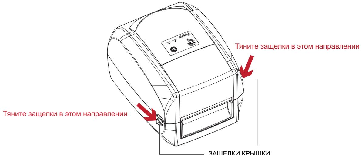
Потяните защелки для открытия крышки принтера
