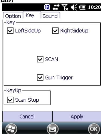
**Остановка сканирования (Scan Stop):** Когда кнопка сканирования поднимается после нажатия, сканирующий луч выключается. Если убрать галочку с опции Scan Stop, сканирующий луч выключается по истечении лимита времени (Timeout), заданного пользователем
