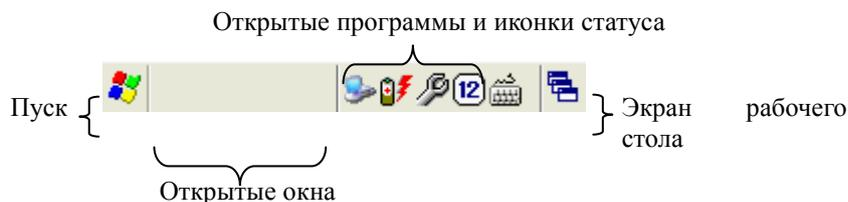
На дисплее коммуникатора отображаются иконки для указания состояния различных компонентов устройства.
