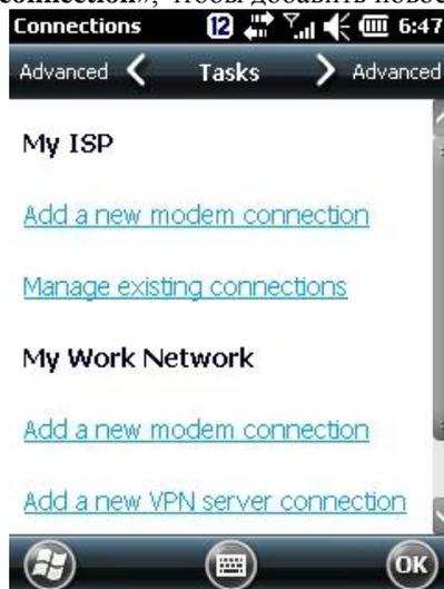
4. Укажите имя подключения в поле **Enter a name for the connection**. Во втором поле выберите **Cellular Line (GPRS)**. Затем нажмите **Next**
