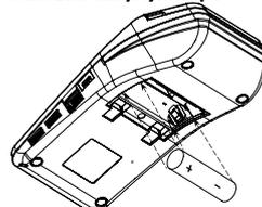
Рисунок 2. Установка аккумулятора
